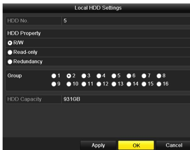
Figure 10. 15 Fenêtre de configuration de disque dur local
