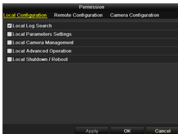
Figura 17–15 Interfața setări permisiune utilizator
