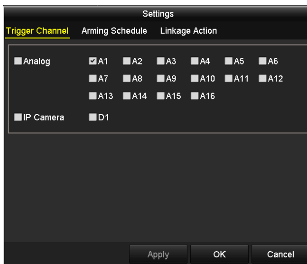
Figura 5–22 setarea camerei de declanșare a alarmei VCA
