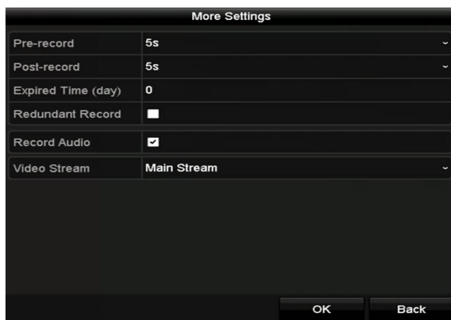
Figura 5–4 Mai multe setări pentru parametri de înregistrare
