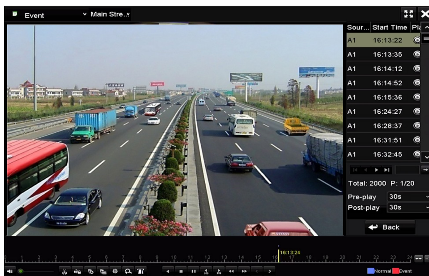
Figura 6–8 interfața redării în funcție de eveniment
