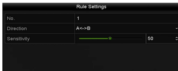
Figura 10–5 setați regulile de detectare a traversării liniei
