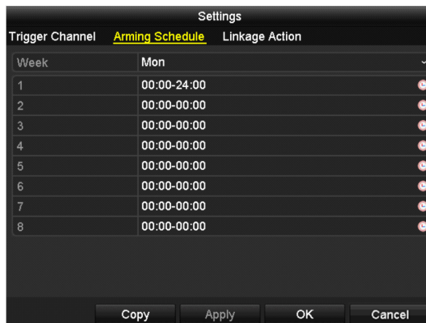
Figure 8. 4 Setare Program armare pentru Detecție mișcare
