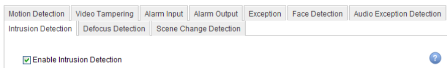
Figur 6–13 Opsætning af detektion af indtrængning for IP-kamera
