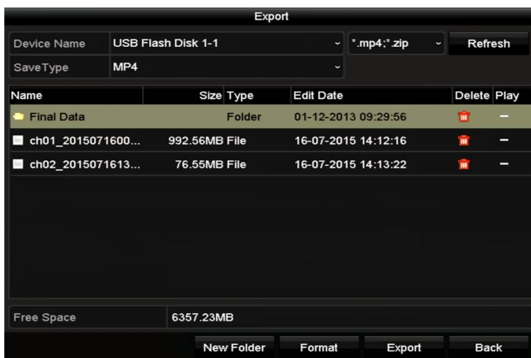
Figur 7–3 Eksportér efter normal videosøgning med USB-flashdrev
