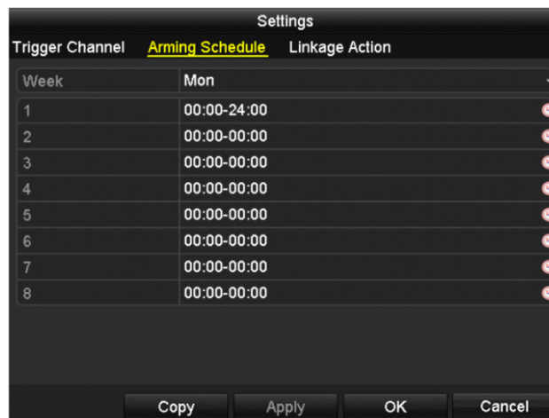
Figur 8–4 Indstilling af armeringstidsplan for bevægelsesdetektion
