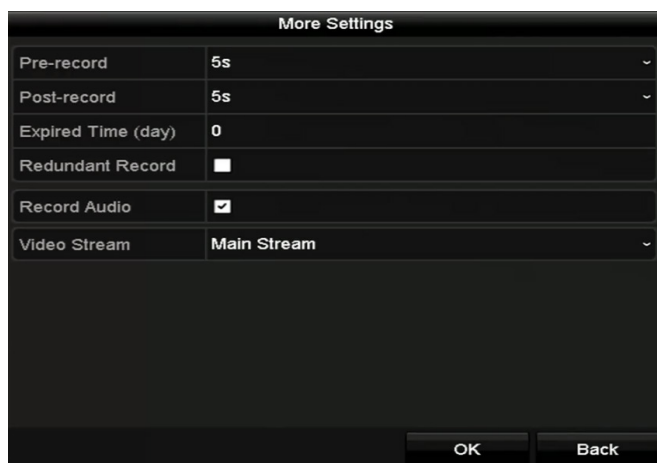
Figur 5–4 Flere indstillinger for optageparametre
