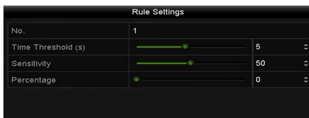
Figur 10–7 Indstilling af regler for detektion af indtrængen ved overskridelse
