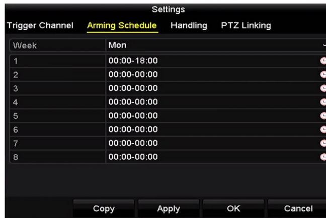
Figur 9–16 Indstilling af armeringstidsplan
