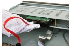
4. Collegare il cavo di alimentazione dell'HDD.
