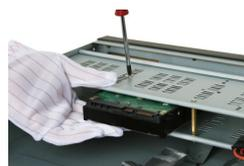
viti in dotazione. Per installarli sul fondo dello chassis è prima necessario rimuovere la parte superiore.
