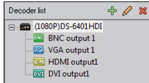
Une fois le décodeur ajouté ses canaux apparaissent dans la [liste de décodeur]. Le décodeur série 6300DI prend en charge la norme VGA et peut donc afficher les sorties BNC et VGA.
