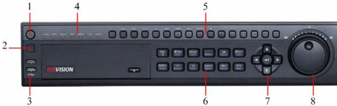
Figure 2. Les commandes du panneau avant du DS-8100 séries.
