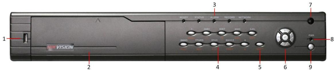
1. **Ports USB :** (Universal Serial Bus) permettant de brancher des périphériques supplémentaires tels qu'une souris USB et un disque dur USB.
