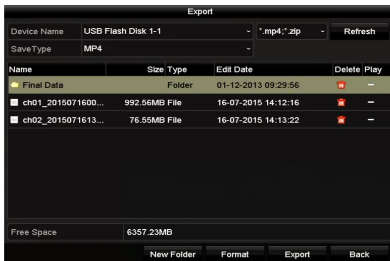
Figura 7–3 Exportar mediante búsqueda normal de vídeo usando un lápiz de memoria USB
