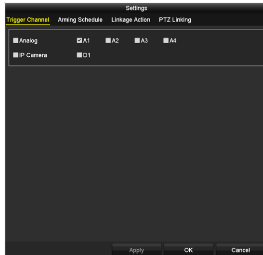
Figura 5–23 Establecer la cámara de activación de la alarma VCA
