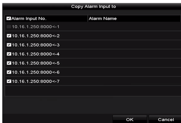
Figura 8–10 Copiar la configuración de la entrada de alarma
