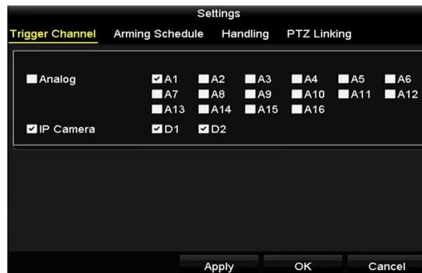
Abbildung 9–15 Auslösekanäle der POS-Kameras einstellen
