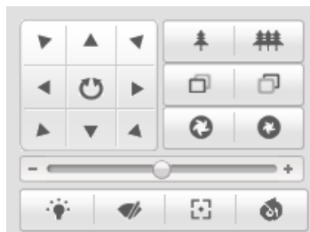
Figura 4-20 Painel de controlo de PTZ
