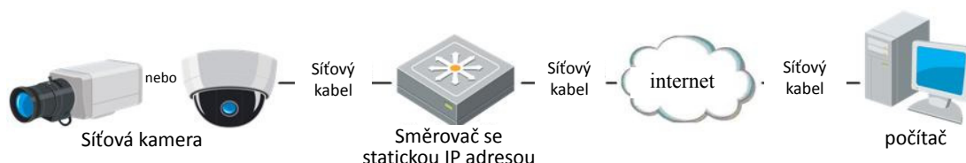
Obrázek 2–10 Přístup ke kameře prostřednictvím směrovače se statickou IP adresou
