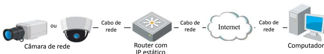
Figura 2–10 Aceder à câmara através do router com um IP estático
