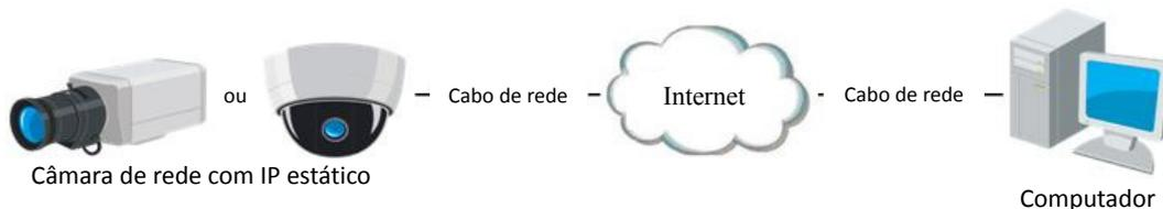
Figura 2–11 Aceder diretamente à câmara com IP estático
