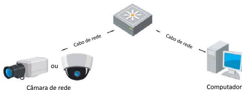
Figura 2–2 Ligar através de um switch ou de um router
