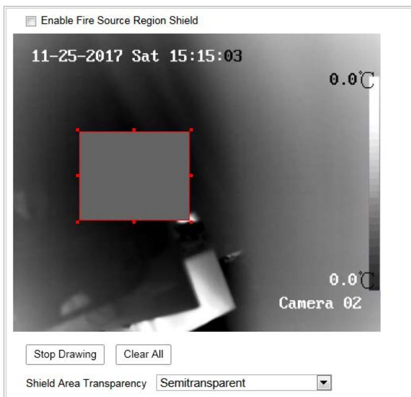
Figura 9–14 Escudo de Detecção de Origem de Incêndio
