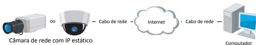
Figura 2–11 Aceder diretamente à câmara com IP estático
