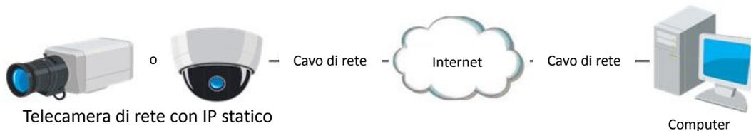
Figura 2-11 Accesso diretto alla telecamera con IP statico
