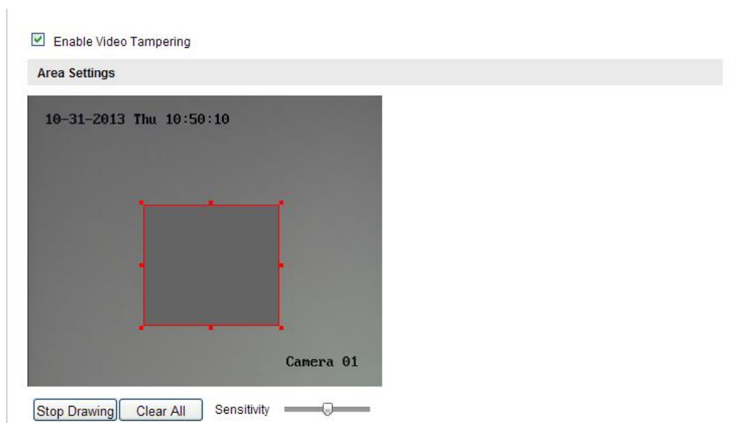
Figure 6-51 Alarme de sabotage vidéo
