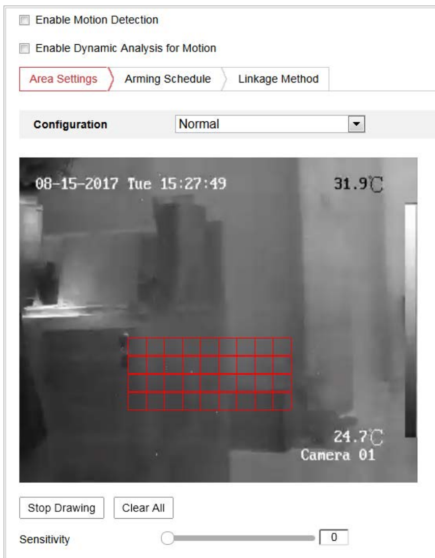
Figura 9–1 Habilitar la detección de movimiento
