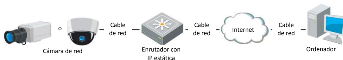
Figura 2–10 Acceso a la cámara mediante router con IP estática
