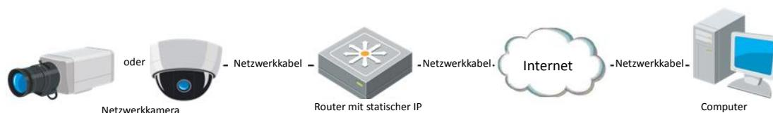
Abbildung 2–10 Zugriff auf die Kamera über einen Router mit statischer IP
