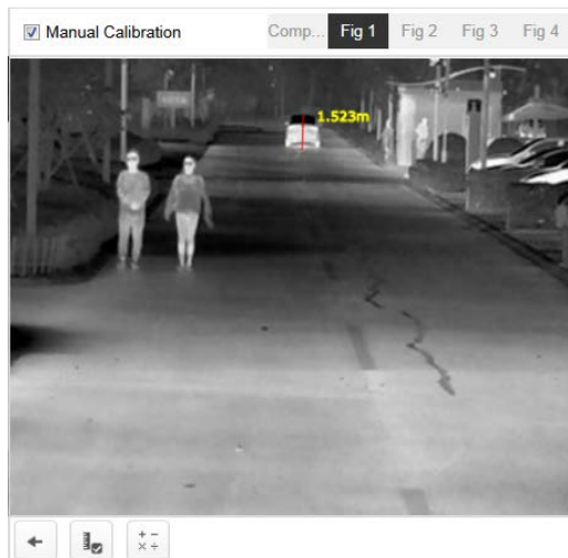
Figure 9–17 Vérification de l'étalonnage
