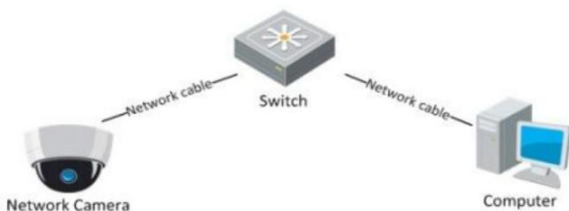
Figure 3-1 Raccordement via le réseau local
