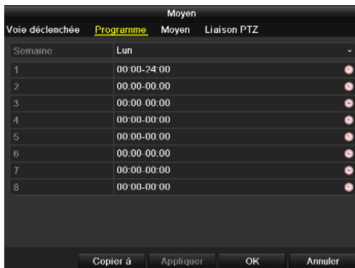
Figure 8.8 Configuration du programme de l'entrée d'alarme
