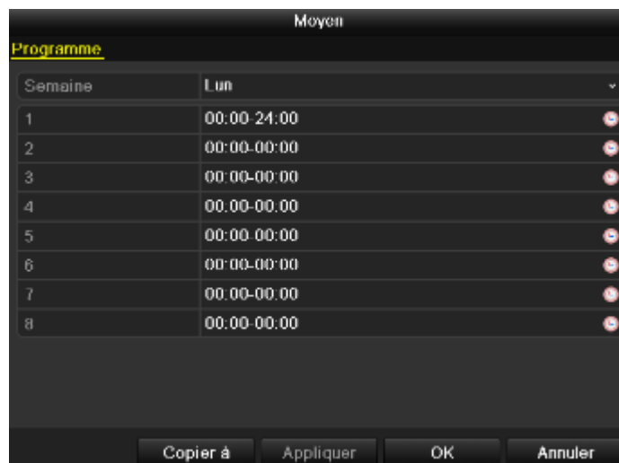
Figure 8.21 Configuration du programme de la sortie d'alarme
