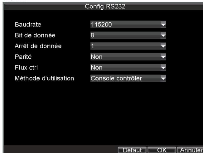
Figure 3. Menu RS-232 Settings (paramètres RS-232)
