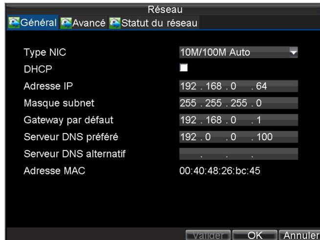
Figure 3. Menu des paramètres réseau
