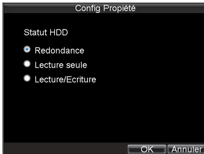
Figure 11. Paramètres de la propriété du disque dur
