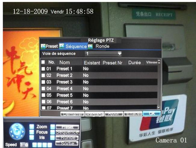
Figure 5. Menu de la gestion de patrouille (point clé config)
