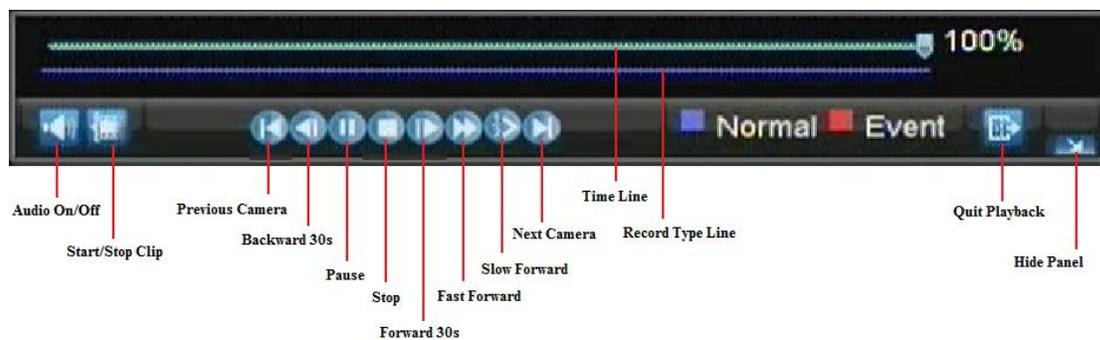
Figure 2. Panneau de contrôle de la relecture
