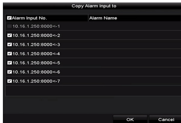
Rysunek 5–20 Kopiowanie wejścia alarmowego
