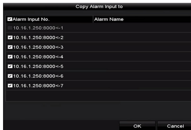
Figura 8–9 Copiar la configuración de la entrada de alarma
