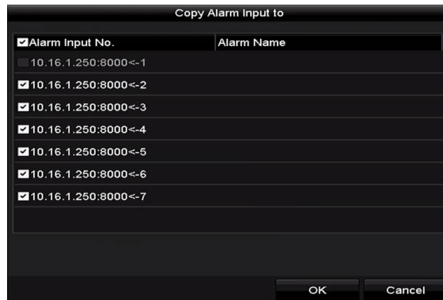
Figura 5–20 Copiar la entrada de alarma
