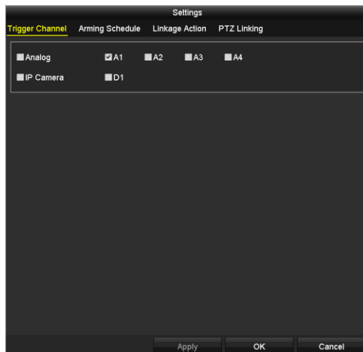
Figura 5-23 Impostazione della telecamera attivata per l'allarme VCA
