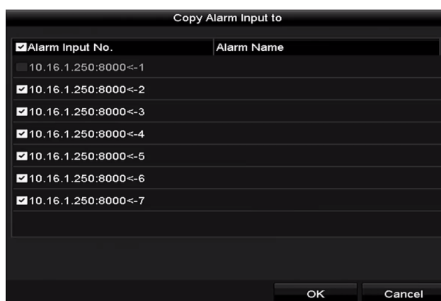
Figura 8-10 Copia delle impostazioni dell'ingresso di allarme
