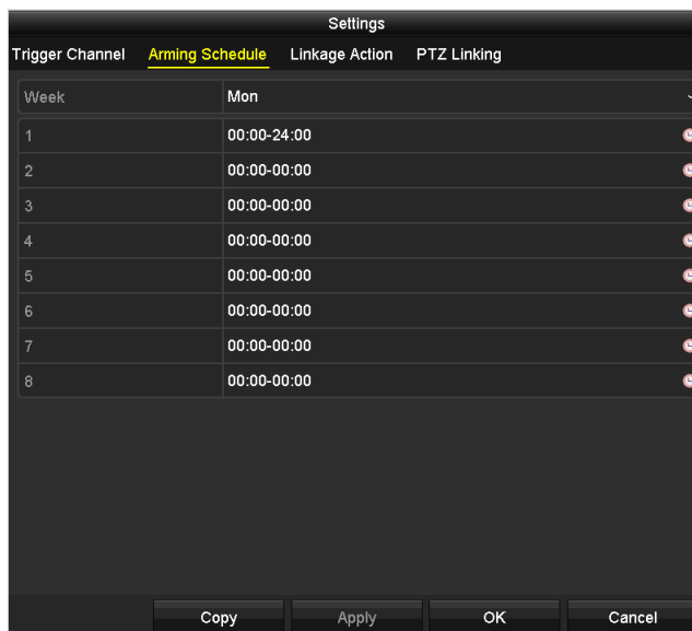
Figura 8-7 Impostazione della programmazione per l'ingresso di allarme
