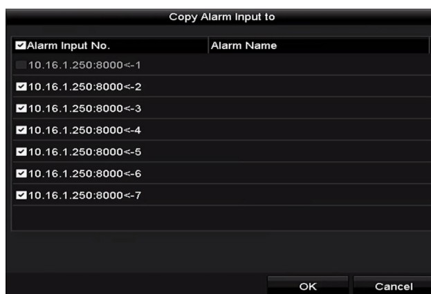
Figura 8-9 Copia delle impostazioni dell'ingresso di allarme
