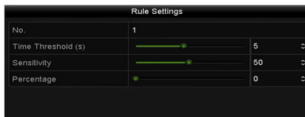
Figura 10-7 Impostazione delle regole del rilevamento di intrusione
