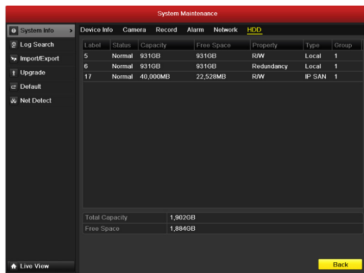
Figura 12.6 Interfaccia delle Informazioni degli HDD
