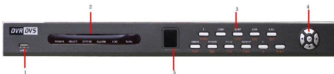
Figura 3: Pannello Frontale del DS-7208HVI-ST/(SE) e DS-7216HFI-ST/(SE/SN)
