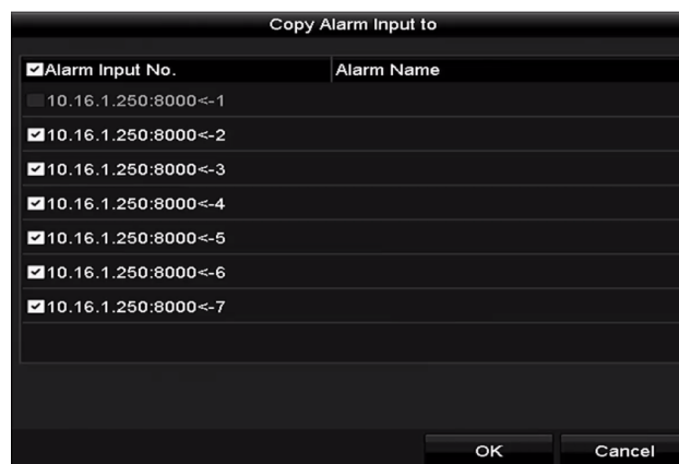
Figure 8–10 Copie des réglages d'une entrée d'alarme
