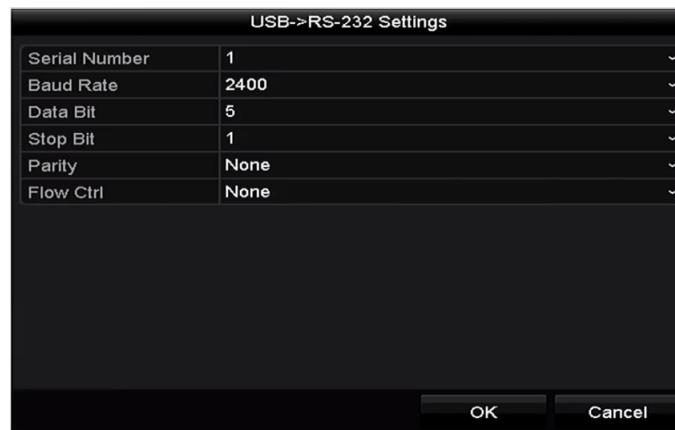
Figure 9–8 Réglages USB vers RS-232
