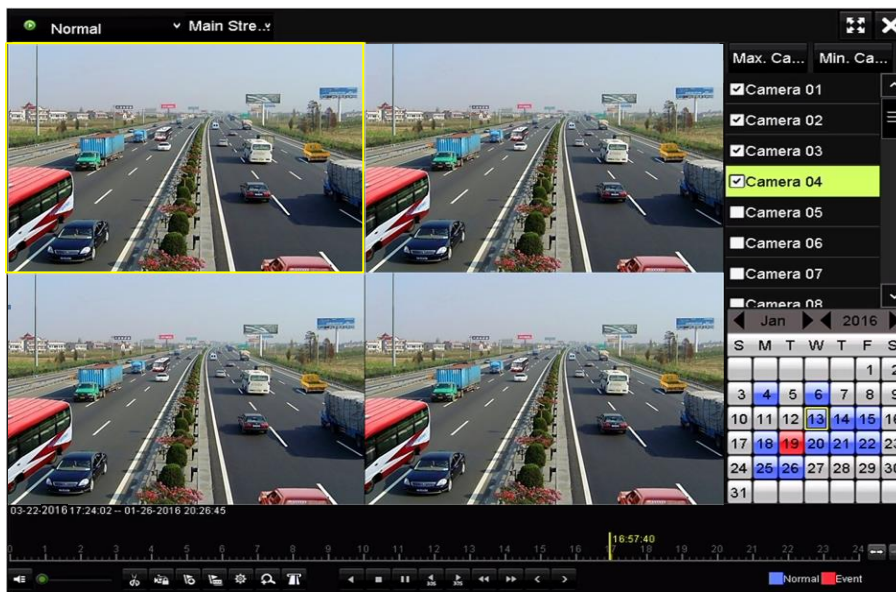
Figur 6–26 Menuen Synkron afspilning af 4 kanaler
