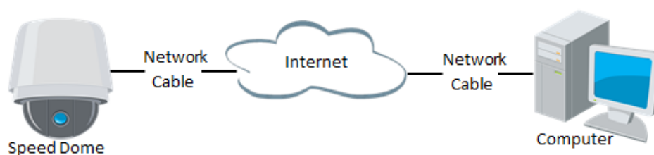
Abb. 2-6 Direktzugriff auf die Speed Dome-Kamera mit statischer IP
