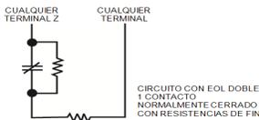
**Figura 2-10 Cableado de DEOL**
