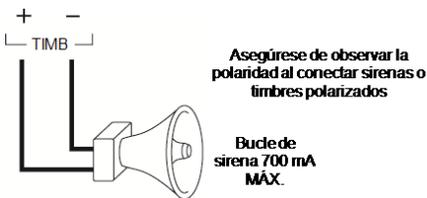
**Figura 2-12 Cableado de terminales Timbre**
