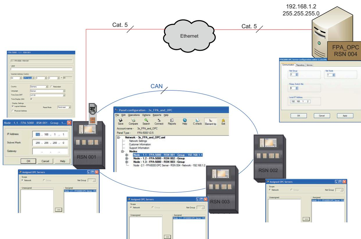
Figura 1.1: Red FPA-5000 controlada por un servidor OPC con una conexión Ethernet simple
