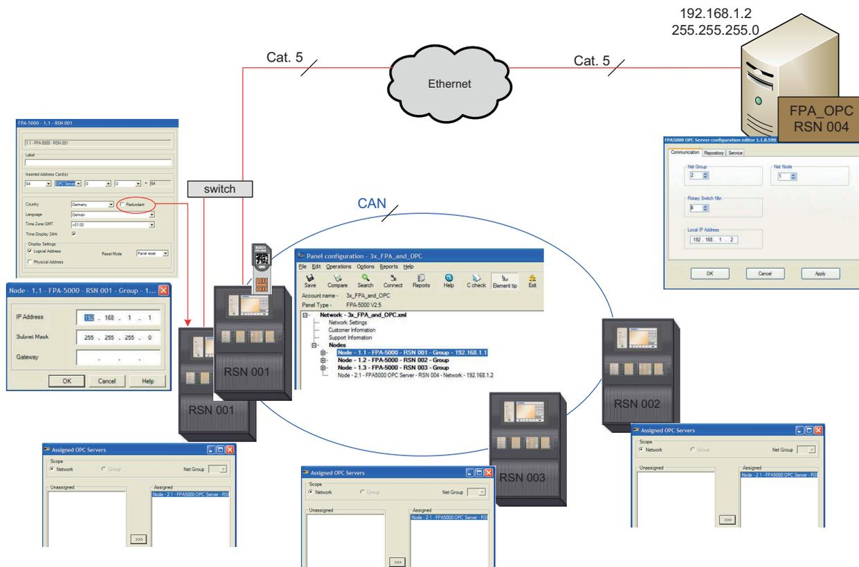
Figura 1.2: Red FPA-5000 controlada por un servidor OPC con una conexión Ethernet redundante
